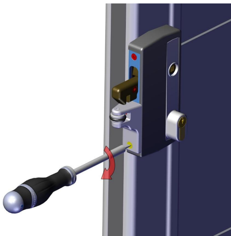
Realiza el apriete del cilindro con el tornillo inox. de cabeza plana M5x70.
