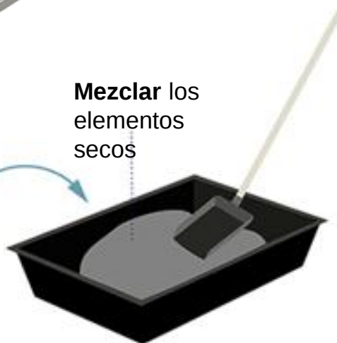
Hasta obtener un hormigón de la consistencia deseada
